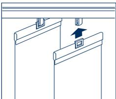
Laufhaken rechtwinklig ausrichten. Lamellen von unten einklippen.
